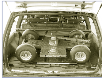
Kompakter Transport, Lenkstange umgelegt
